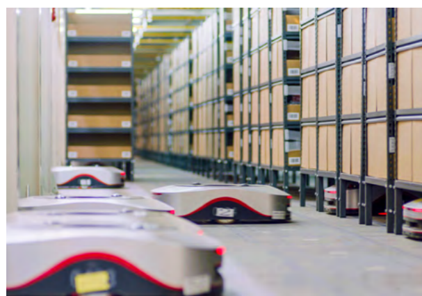
中国电信 5G 专网能力助力 AGV 小车实现规模化协同运转。图为正在作业中的 AGV 小车
